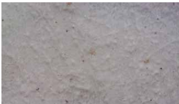
FIGURA 12. Visualización general de la superficie de un filtro de SDI de 0,45 µm a la salida de los filtros de cartuchos, con magnificación de 40x. Gentileza de Facet Ibérica.
